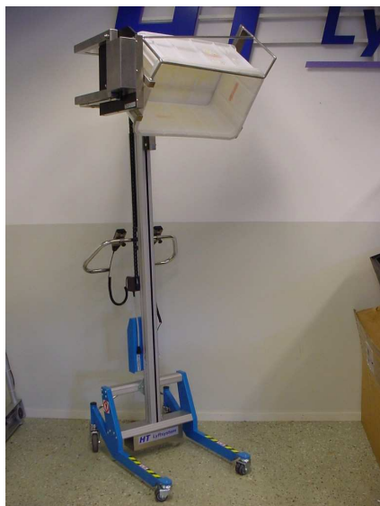
Charkindustrialösningar, tömning av back med elektrisk tippfunktion
