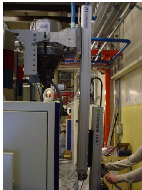
Industrianpassningar, här med teleskopmast
